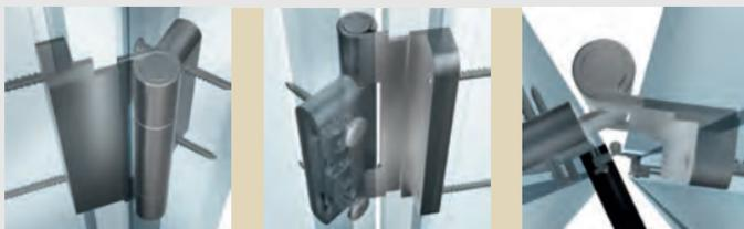
**Drei 3D-Bänder** von extra schwerer Qualität sind in die Tür eingelassen. Eines allein könnte 160 kg tragen. In unseren Türen halten drei an der Zahl die Tür in der Waagerechten. Einstellarbeiten können im eingehängten Zustand vorgenommen werden, einfach mit dem Inbusschlüssel.
