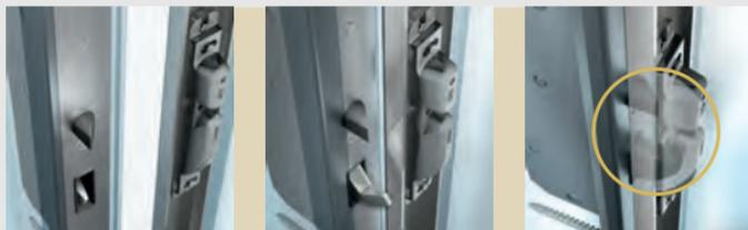
**Zwei Rundbolzen plus regulierbare Schwenkriegel** wirken wie Anker. Im oberen und unteren Bereich fassen sie tief in den Rahmen. Die zwei Rundbolzen fahren immer automatisch in den Rahmen, sobald die Tür ins Schloss fällt.
