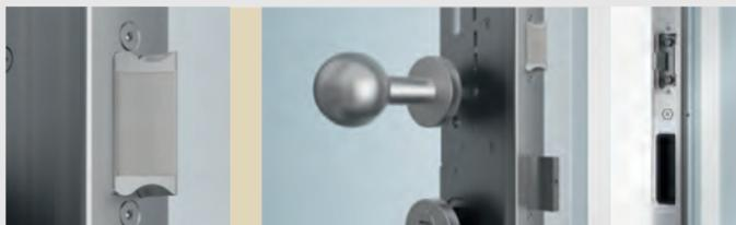
**Riegel und Falle** sorgen mittig für eine solide Verbindung mit der Zarge. Sämtliche Rundbolzen und die Falle unseres Haustürschlosses sind mit einem Mantel aus extrem abriebfestem Polyoxymethylen (POM) überzogen. Das sorgt für Wartungsfreiheit, die Tür schließt extrem leise und sehr leichtgängig.
