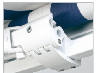
Kippgelenkarmlager mit selbstverriegelnder Hochschlagsicherung. Kippteile gesenkgeschmiedet
