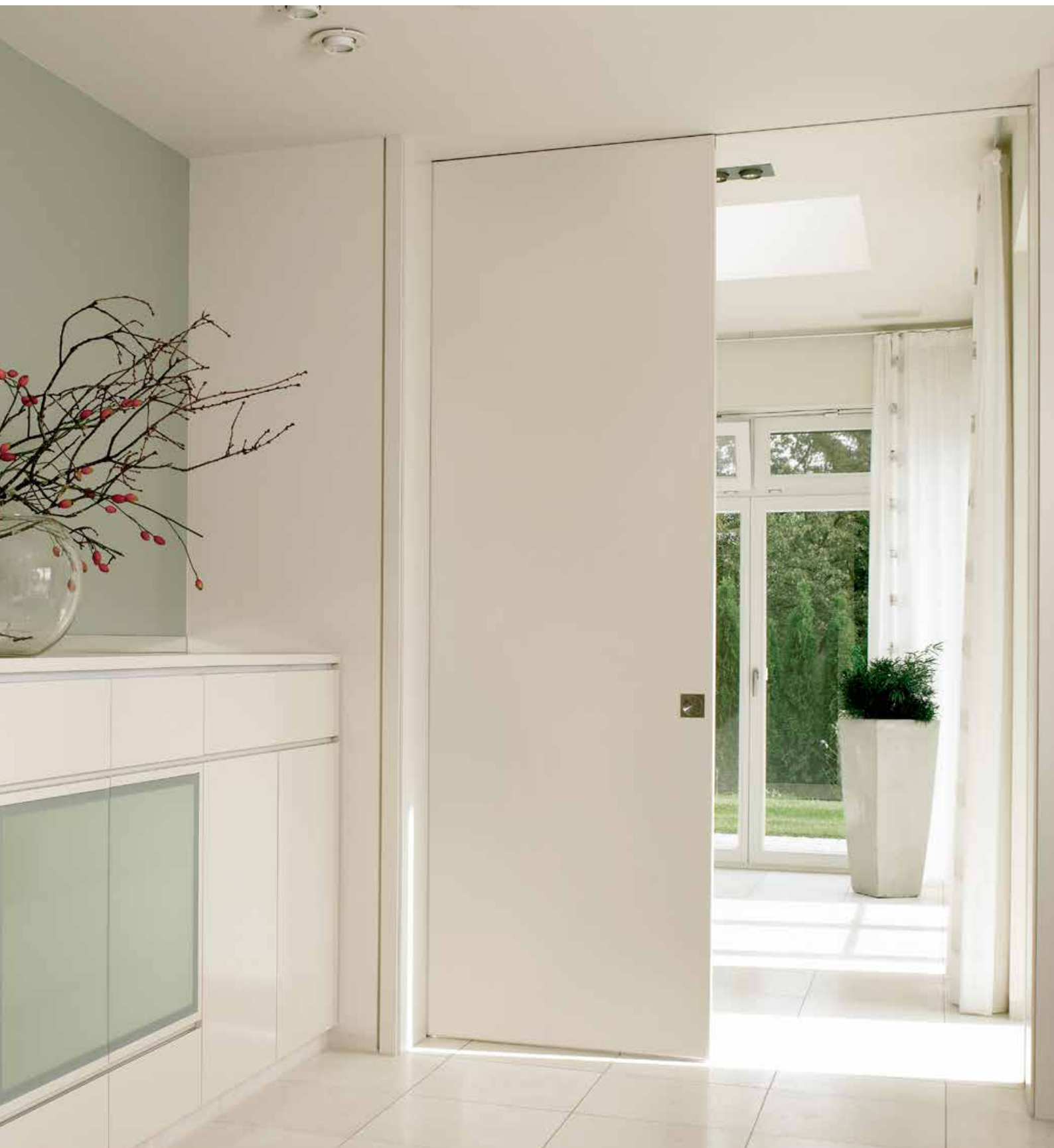
Doppelschiebetür Typ G | verdecktliegende Schiebetürschiene | Schleiflack RAL 9010 Zarge K50, wandbündig mit hinterschraubten Winkelprofilen | raumhoch ohne Querstück
