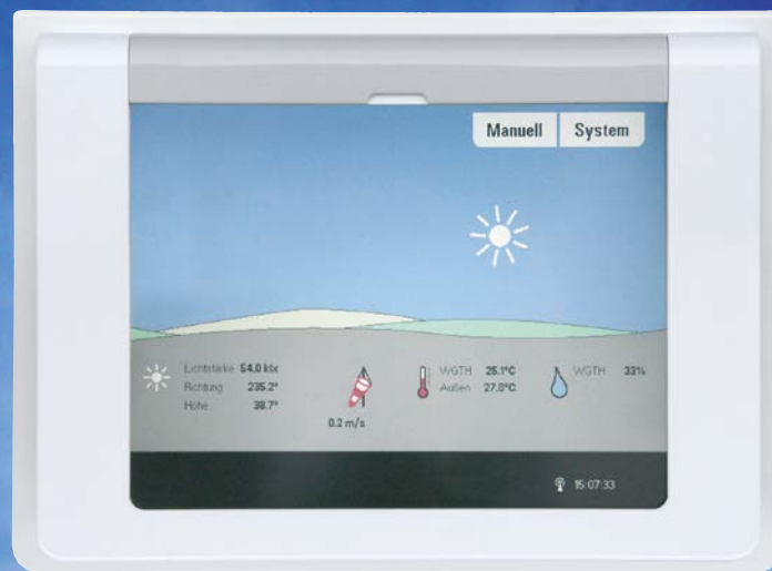
Zentraleinheit mit Wetterstation und Innensensor für Wintergartensteuerung
