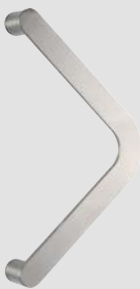
Nr. 4146: Stoßgriff Dreiecks-form, Flachprofil 30 x 8 mm, angeschweißte Stützen, Achs-maße 300 mm
