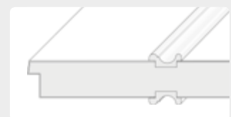
Türblatt mit eingefrästen und aufgesetzten Leisten.
