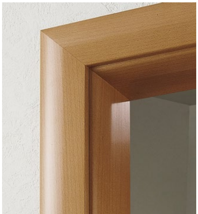
Die neue Zarge überdeckt jeweils den Wandansatz mit der Bekleidung. Das macht Tapezieren oder aufwändiges Nacharbeiten überflüssig.
