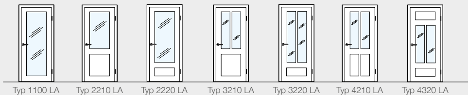
Türblatt mit eingefrästen und aufgesetzten Leisten.
